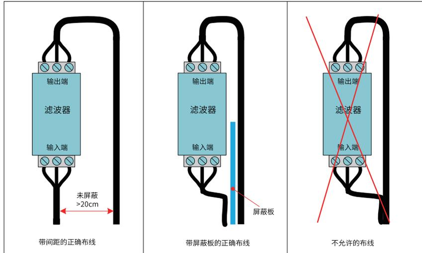
图4-4 电源滤波器的安装示意图
