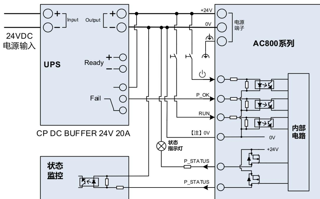
【注】0V信号在内部已经和电源端的0V接通，正常使用时无需接线。
