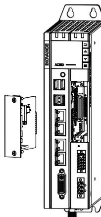
图1-1 扩展卡插槽结构示意图
