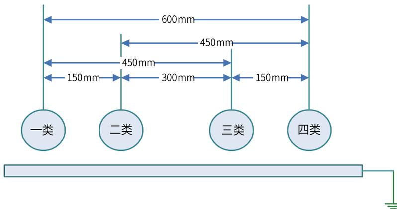
图4-3 各类型线缆布线要求示意图
