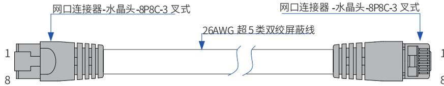
图4-18 EtherCAT网线制作要求
