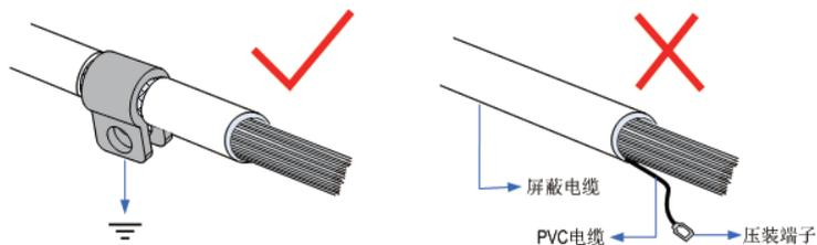
图4-2 屏蔽线缆接地要求示意图
