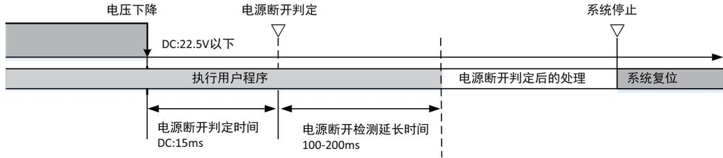
经过电源断开判定时间后，即使电压复位，PLC仍会停止运行，如下图所示：
