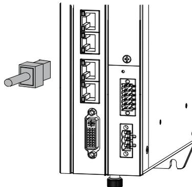
图4-16 RJ45网线连接示意图
