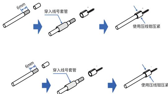
图4-20 针形线缆制作示意
