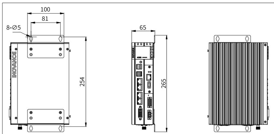
图3-3 控制器安装尺寸 - 侧面挂耳
