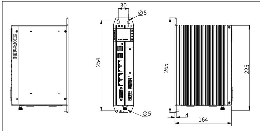
图3-2 控制器安装尺寸 - 背面挂耳
