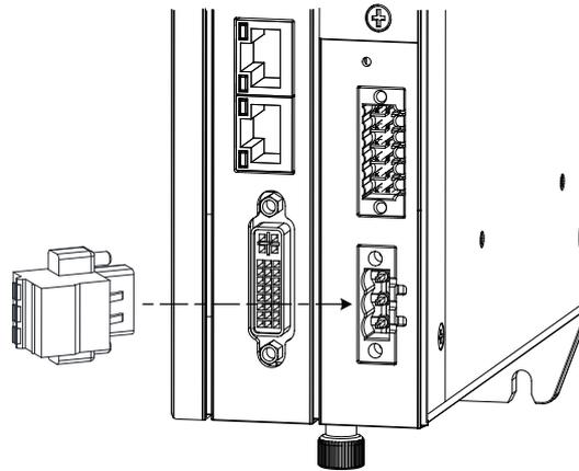
图4-5 电源输入端子接线示意图
