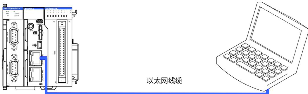
图 5-29 CPU 模块与 PC 连接
