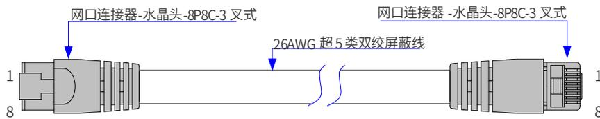
图 5-20 EtherCAT 网线制作要求
